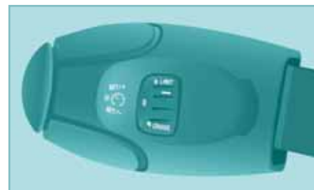
Limitador de velocidad
